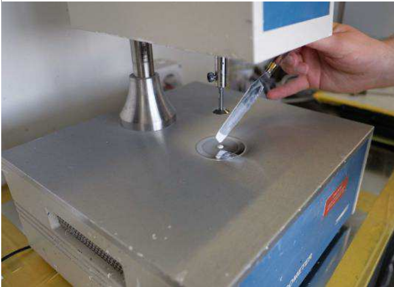
Dem Viskosimeter genügt ein Tropfen Farbe, um die Spannungseigenschaften zu bestimmen. (Bild: Marcus May)
