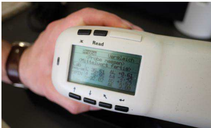
Ein modernes, bereits stark miniaturisiertes Farbmessgerät, das die Werte in Zahlen ausgibt. (Bild: Marcus May)
