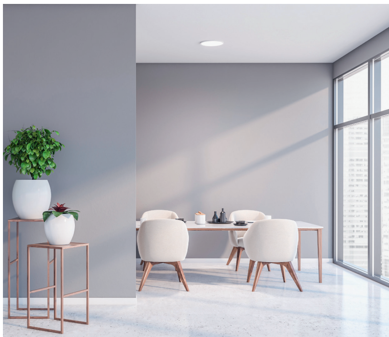
Früher dominierten kleine Fenster, heute grossflächige Verglasungen. Mehr Streiflicht erfordert tuchmatte, streifenfreie Wandfarben.
